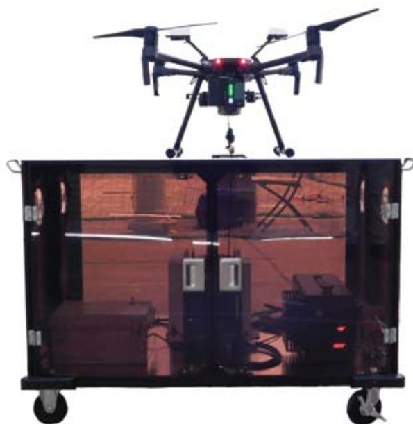
図2 有線ドローン点検装置「D-road」
